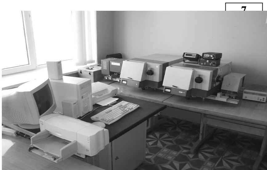
Рисунок 7.9. Зовнішній вигляд установка для вимірювання спектральних характеристик чутливості електронно-оптичних приладів ИДНМ4.011.00.00
