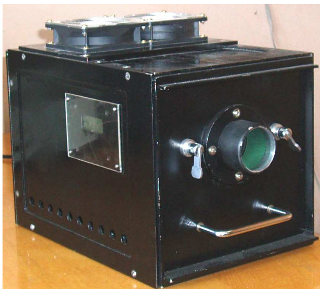
Рисунок 7.1. Джерело УФ випромінення (освітлювач).
